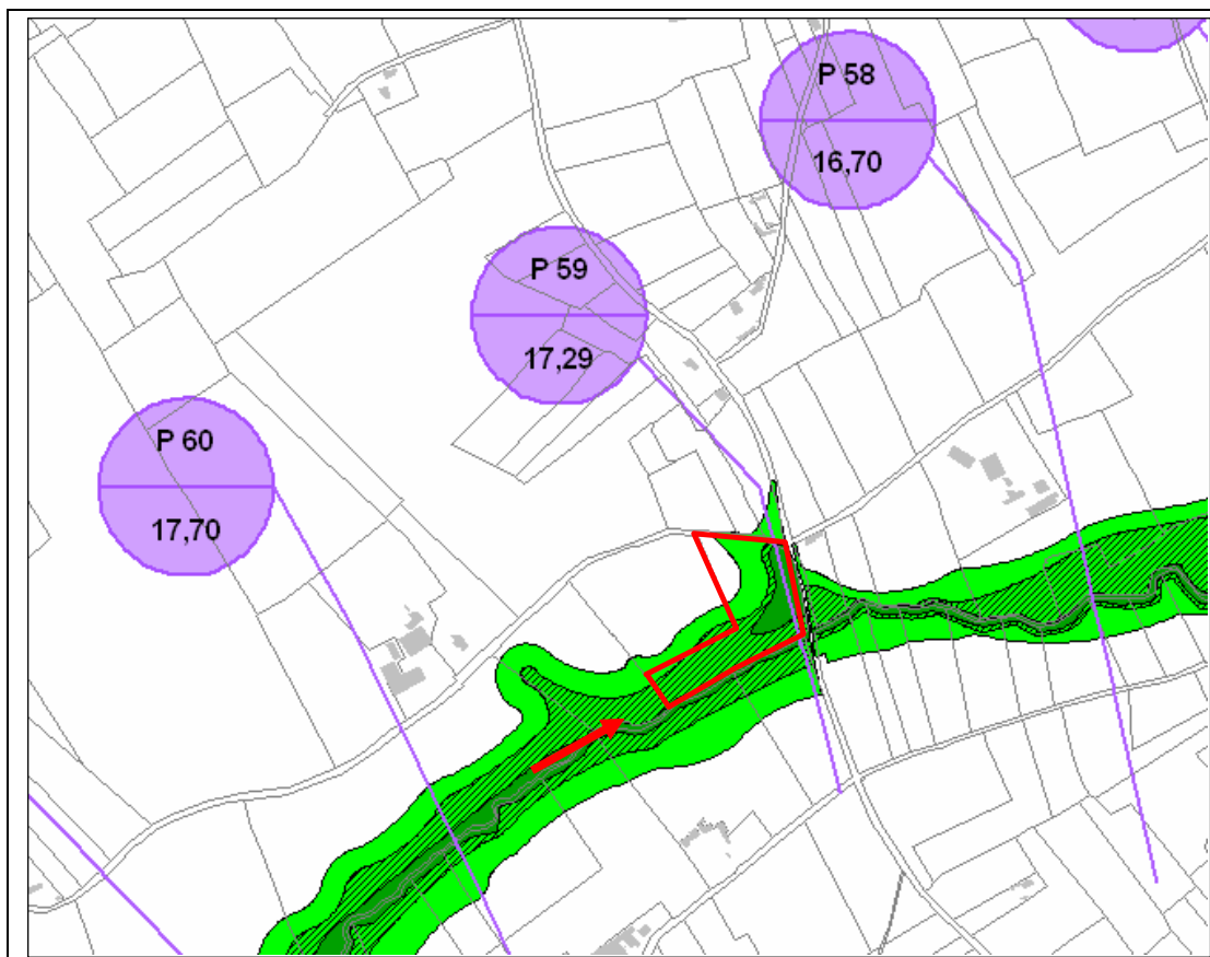
Schéma de principe de définition de la cote de crue centennale au droit de la parcelle aménageable entourée de rouge
